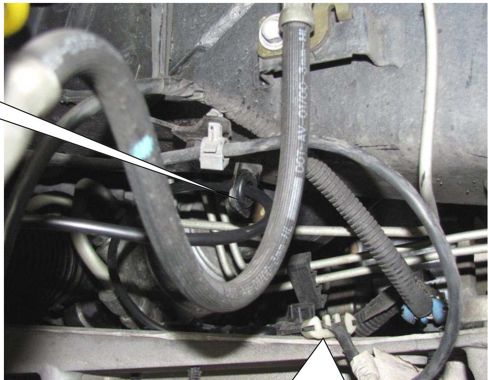
Originale Dämpfersteuerungsleitung in das mitgelieferte Elektronikbauteil einstecken.
