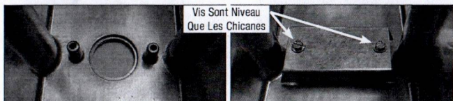
Fig 1. - Installation du Déflecteur de la Plaque Assurez-vous d'utiliser le casier de fil ou de silicium sur les filets des vis pour empêcher les vis de se desserrer au fil du temps.
